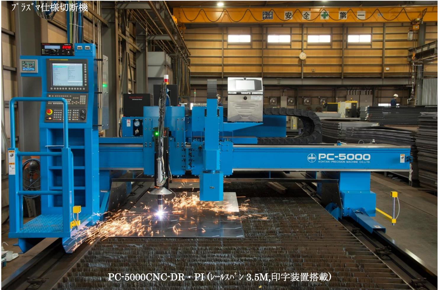
PC-5000CNC-DR・PI (レールスパン 3.5M, 印字装置搭載)
