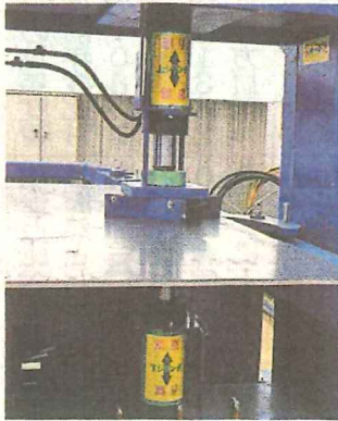
敷板矯正機「修平くんモデルSKT」（岩上鋼材・伊勢崎事業所内）①、敷板を上面・下面から同時にプレス
