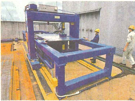
敷板矯正機「修平くんモデルSKT」（岩上鋼材・伊勢崎事業所内）①、敷板を上面・下面から同時にプレス
